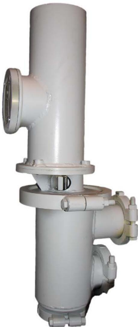
Клапан предназначен для обеспечения циклического режима замера количества (дебита) газа, воды и нефти при попеременном заполнении газом и водонефтяной смесью измерительной камеры емкости сепарационной.
