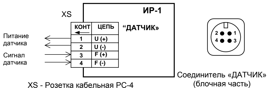
Рис.2. Подключения к ИР датчика ДРС.М
