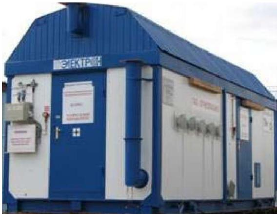
Установка предназначена для автоматического измерения количества жидкости, добываемой из нефтяных скважин с последующим определением дебита скважин.
